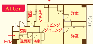
築年数38年の3LDKマンションを2LDKに変更。動線にも配慮してキッチン・和室・床・水まわりを一新、収納とワークスペースを増設しました。
